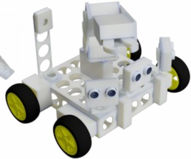
Διάταξη με δύο κινητήρες και πολλαπλούς αισθητήρες
